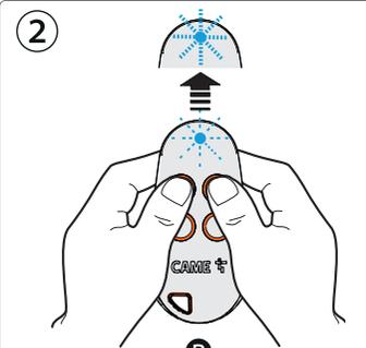
**IT** - Inizia la clonazione del nuovo trasmettitore. Tieni premuti i primi due tasti del nuovo trasmettitore per circa 5 secondi, fino a quando il LED inizia a lampeggiare velocemente.
