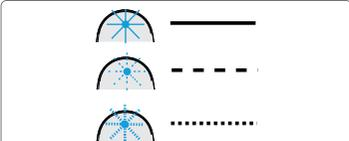
**IT** - Elenco dei tipi di lampeggio. La luce del LED può essere accesa fissa, può lampeggiare lentamente oppure può lampeggiare velocemente.
