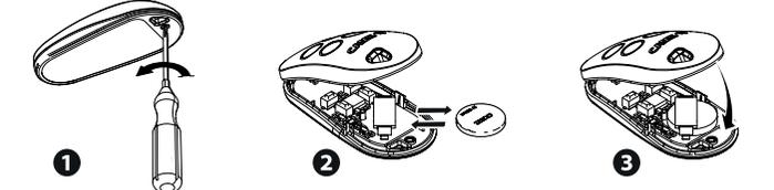
**IT** - Per sostituire la batteria, rimuovere il guscio superiore utilizzando un cacciavite.
